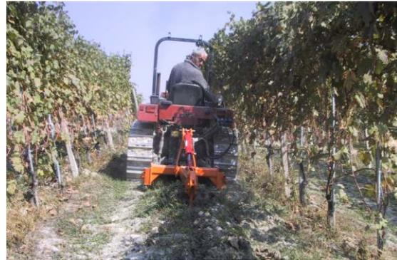
Per dissodare e arieggiare a grandi profondità. Il Ripuntatore è dotato di uno snodo posto dietro l'attacco a tre punti che per mezzo di un cilindro idraulico permette un maggior sollevamento da terra ed una più ampia funzionalità di lavoro. L' attrezzo è dotato inoltre di bullone di sicurezza collegato all' ancora interamente costruita in acciaio antiusura e dotata di più fori per la regolazione dell'altezza. A richiesta è anche possibile applicare un disco anteriore.
